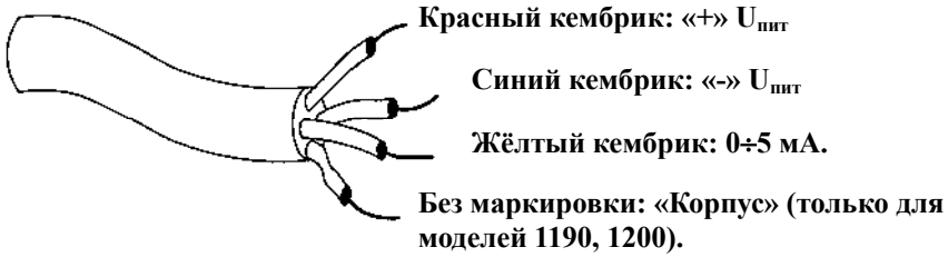
Рис.5-3. Значение цветной маркировки жил кабеля для моделей с типом электроконтактного соединения КЗ (Таблица 18).
